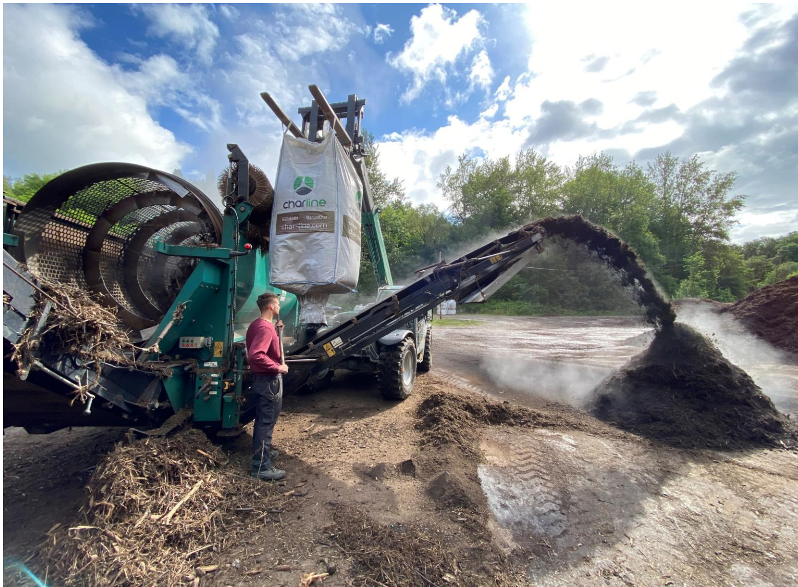
Einmischung von Pflanzenkohle in Grünschnittkompost (Versuch)
