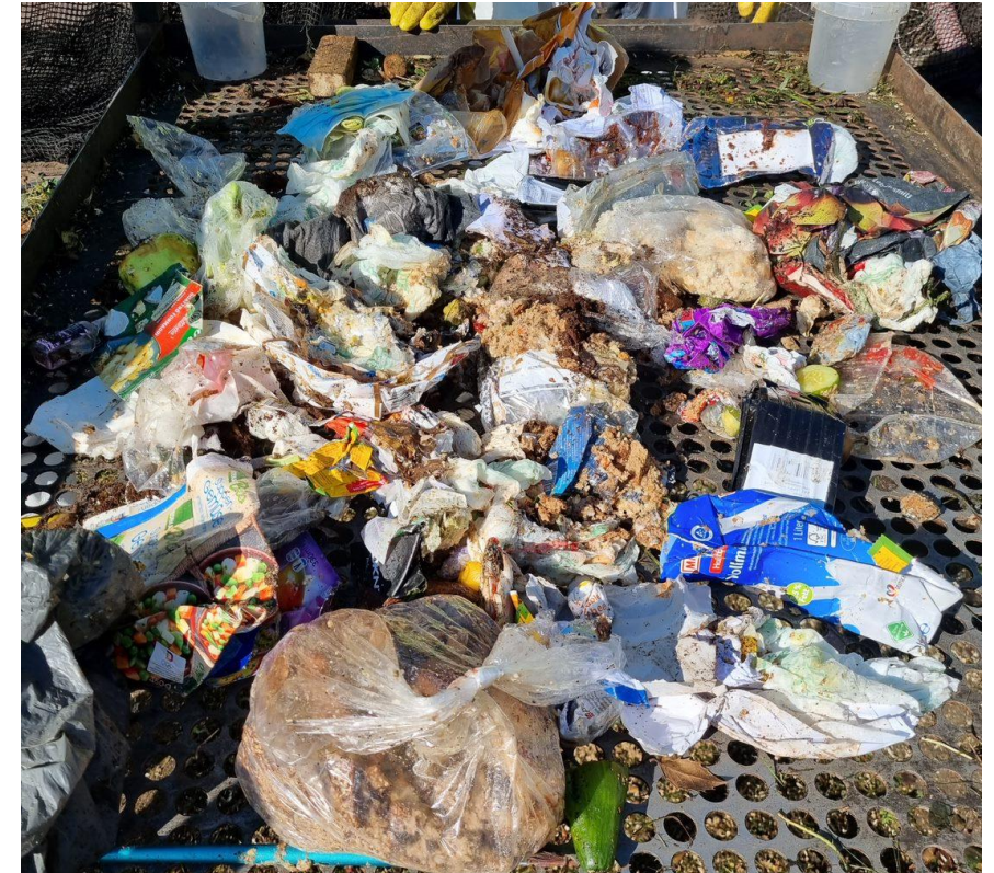
Abbildung 23: Störstoffe auf Sortiersieb
